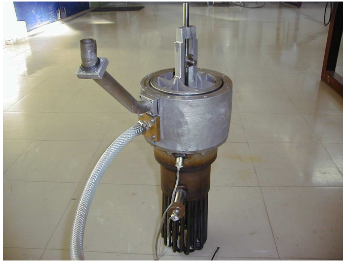
FIG. 2.3 : Partie inférieure, du moteur ST05G, démontée, et capteurs de températures T_{KR} et T_{RH}
