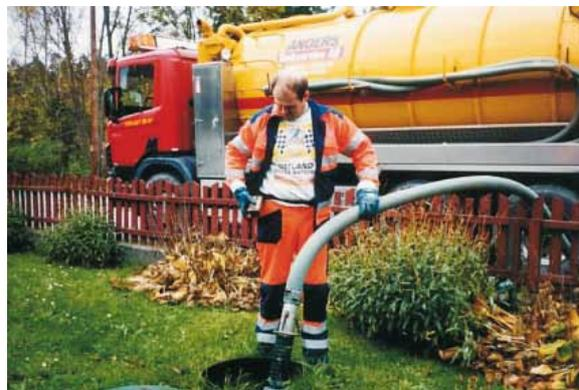
Figure 24: Vidangeur conventionnel, recueillant les boues provenant des fosses septiques.
