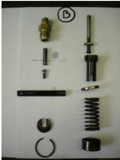
Pompe B démontée
