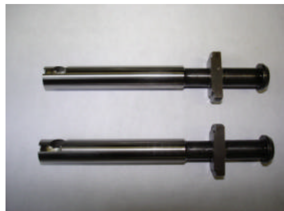
Éléments de pompage A et B
