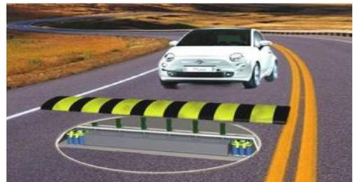
Figure 1: schéma descriptif du ralentisseur intelligent
